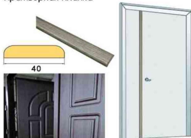
Находится с внутренней стороны двери, закрывает щель, образуемую между створками, улучшает тепло- и шумоизоляцию. Обязательный элемент двустворчатых дверей
