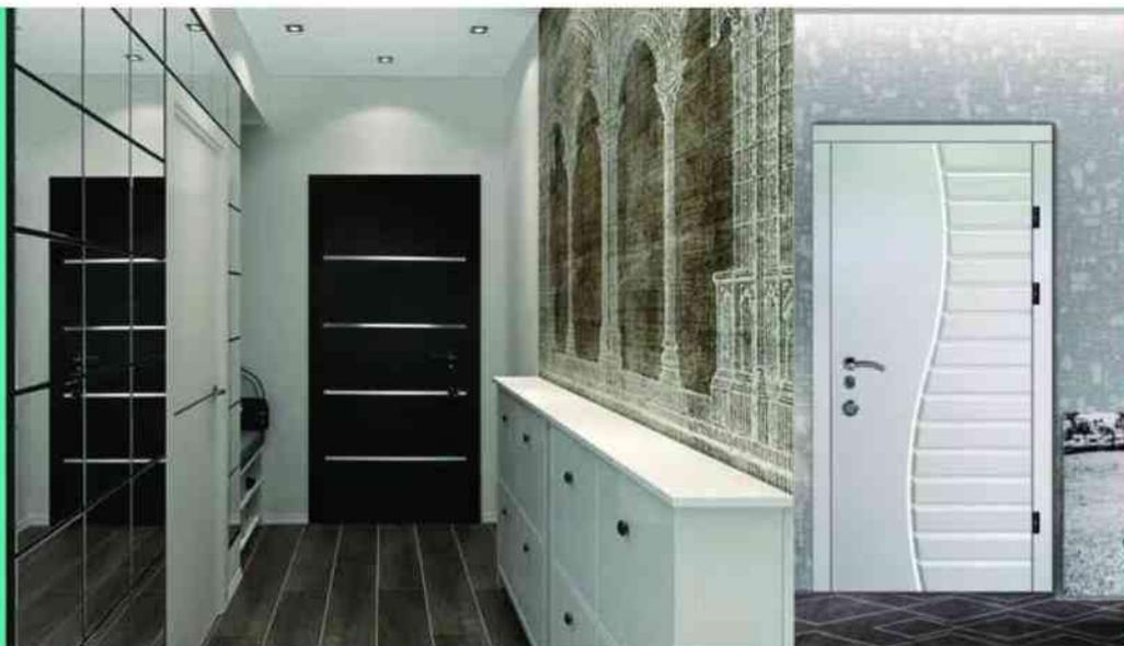
Двери утепленные, звукопроницаемые, хорошая тепло- и шумо-изоляция, толщина металла 1,5 мм, МДФ 16 мм
